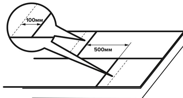
**5** При использовании в качестве временной кровли дополнительно зафиксировать рейками или пятаками с шагом 50см
