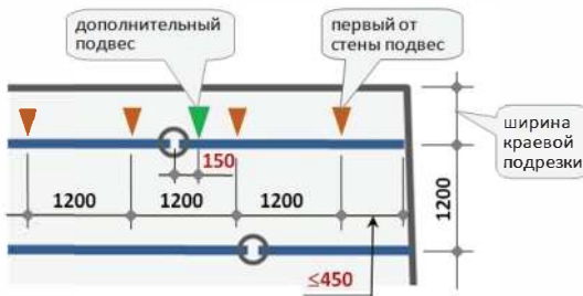
Рис. 25. Размещение подвесов вдоль несущей рейки
