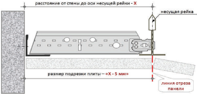
Рис. 50. Правильная обрезка панели
