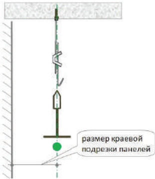
Рис. 42. Совпадающие оси подвеса, ряда несущих реек и установочного шнура
