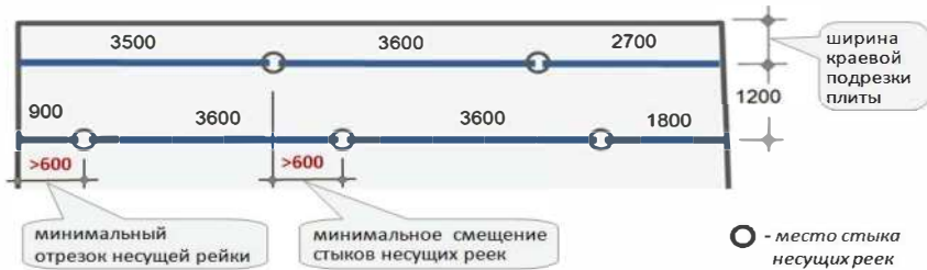
Рис. 24. Смещение стыков несущих реек, минимальный отрезок несущей рейки
