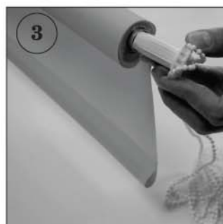
3 Вставить в штангу цепочный механизм.
