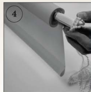
4 Установить цепочный механизм с одной стороны штанги, с другой стороны вставить заглушку.
