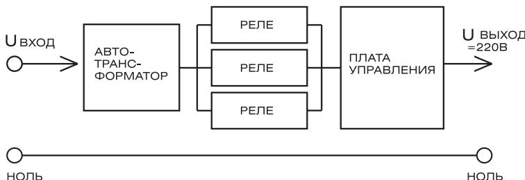
При включении стабилизатора входное напряжение поступает на автотрансформатор, далее электронные компоненты стабилизатора анализируют входное напряжение и, используя полученную информацию, плата управления включает поочередно силовые ключи (реле) до того момента, пока выходное напряжение стабилизатора не будет установлено в пределах, указанных в Таблице 1, после этого на выходные клеммы стабилизатора подается напряжение.
