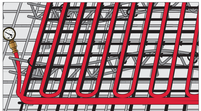
Рис. 8-28 Шаг 4: Произвести испытания сжатым воздухом
